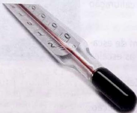
Fig. 1.4 Termómetro de álcool com corante
