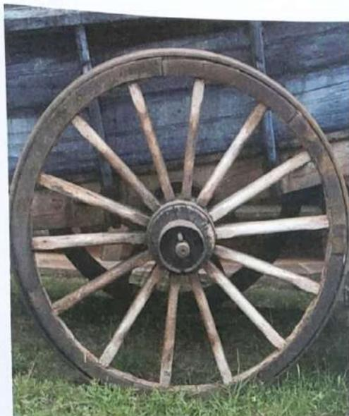
**Fig. 1.13** Aro metálico de uma roda de madeira de uma carroça
