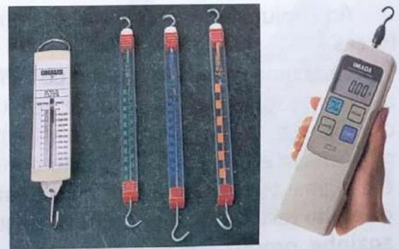
Fig. 2.6 Tipos de dinamómetros. O modelo da direita é digital.
