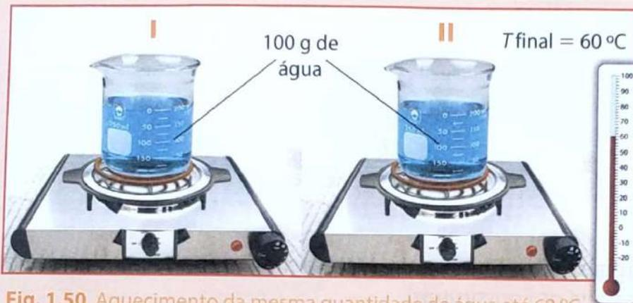
Fig. 1.50 Aquecimento da mesma quantidade de água até 60 °C.
