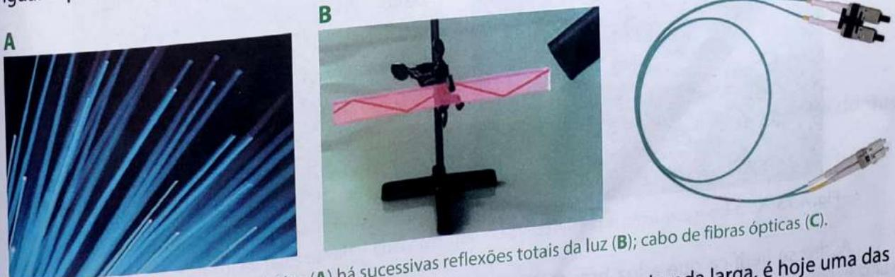
Fig. 4.72 Numa fibra óptica (A) há sucessivas reflexões totais da luz (B); cabo de fibras ópticas (C).
