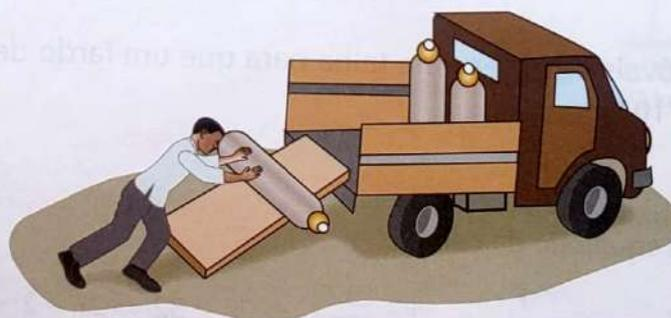
Fig. 2.47 O uso do plano inclinado para carregar um camião.
