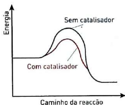
Fig. 38 – Energia de activação com e sem o uso de catalisador.
