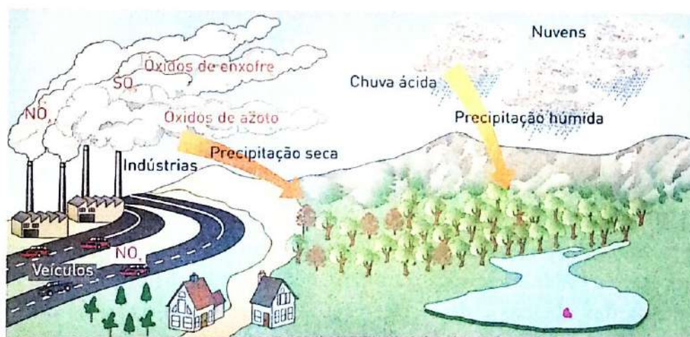
Fig. 9 – Esquema explicativo da formação das chuvas ácidas.
