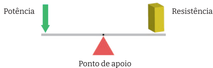
Fig. 9 Constituição de uma alavanca interfixa.
