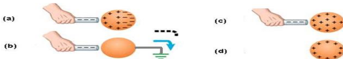
Fig.3. Electrização por indução
