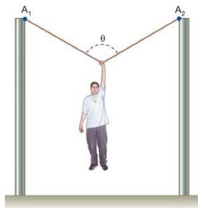
11. Na figura, a corda ideal suporta um homem pendurado num ponto equidistante dos dois apoios ( $A_1$  e  $A_2$ ), a uma certa altura do solo, formando um ângulo de  $120^\circ$ . A razão  $T/P$  entre as intensidades da tensão na corda ( $T$ ) e do peso do homem ( $P$ ) corresponde a:
