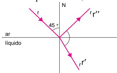
Sendo os índices de refração absoluto do ar e do líquido iguais, respectivamente, a 1 e  $\sqrt{2}$ , o ângulo indicado no esquema é:
